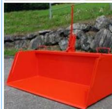
Mechanische Transportverriegelung, Aufnahme Kat. 1 + 2, Hand- oder Seilzug-Betätigung, Befestigungsvorrichtungen an Rückwand, Verschleisschiene und 2 Verschleisskufen aus Spezialstahl. Auf Wunsch mit Abschlussdeckel, resp. Rückwanderhöhung.
